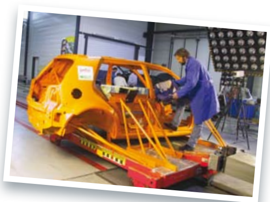
Preparación del crash test de sillitas del grupo 1.
